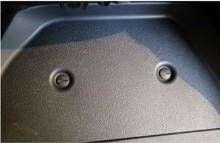
Lösen Sie die Verriegelungsschrauben im Beifahrerfußraum und nehmen Sie die Abdeckung für das Werkzeugfach ab.
