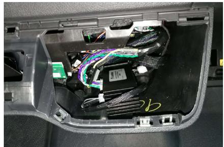
Schließen Sie den Verstärker an und verstauen ihn unter dem Ablagefach in der Mittelkonsole. Sichern Sie den Verstärker außerdem mit dem beiliegenden Klettband gegen Verrutschen.
