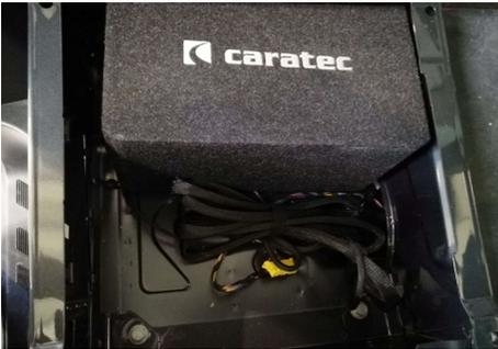
Schließen Sie den Subwoofer an und verstauen ihn unter dem Beifahrersitz. Mit dem beiliegenden Klettband können Sie den Subwoofer am Sitzgestell fixieren.
