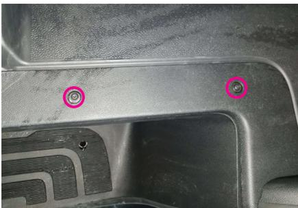
Drehen Sie die zwei Schrauben (Torx 20) im Beifahrerfußraum heraus und nehmen Sie die Verkleidung in L-Form ab.
