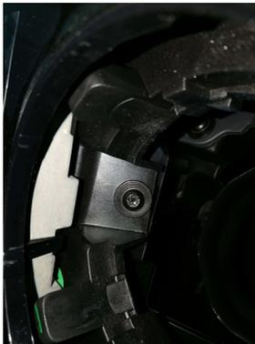
Hinter den beiden Düsen befindet sich jeweils eine Schraube (Torx 20). Diese muss herausgedreht werden.
