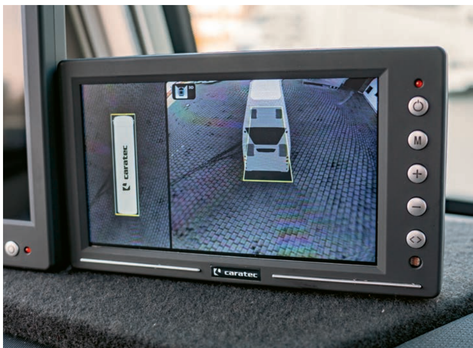
Das 360° Birdview-Kameraset mit 3D-Ansicht zeigt das Fahrzeugmodell von hinten und eine Draufsicht. So haben Sie alles im Blick.
